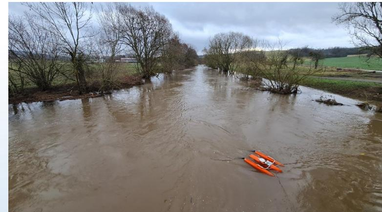
Abb.: Abflussmessung am Pegel Bennungen
