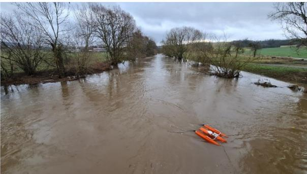
Abb.: Abflussmessung am Pegel Bennungen / Helme
